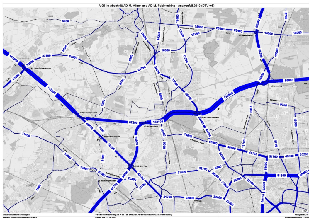
Abbildung 4: Verkehrsbelastungen im Bereich des Tunnel Allach (Autobahn und nachgeordnetes Netz) (Quelle: ABDS)
